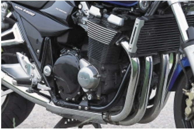
Hochentwickelte Technik: luft-/ölgekühlter Motor (SACS), Schmiedekolben, beschichtete Zylinder (SCEM), Einspritzanlage mit zwei Drosselklappen (SDTV).
